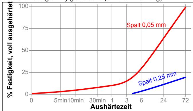
**Aushärtegeschwindigkeit in Abhängigkeit vom Material**
