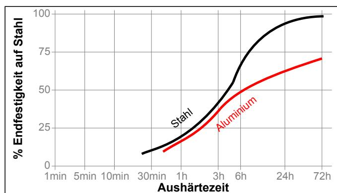
**Aushärtegeschwindigkeit in Abhängigkeit vom Spalt**
