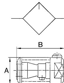
Festeingestellte Öldosierung: ca. 0,4 cm<sup>3</sup> pro 100 Arbeitstakte, eine Füllung = 3000 Arbeitstakte.
