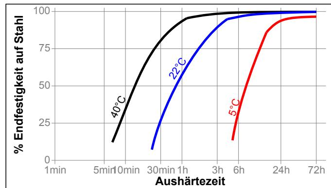
**Aushärtegeschwindigkeit in Abhängigkeit vom Aktivator**
