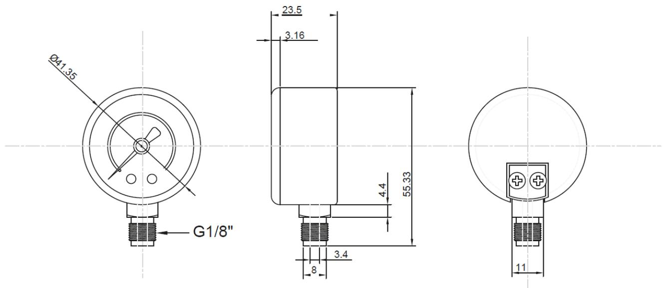
**Standardmanometer, Anschluss radial unten**
