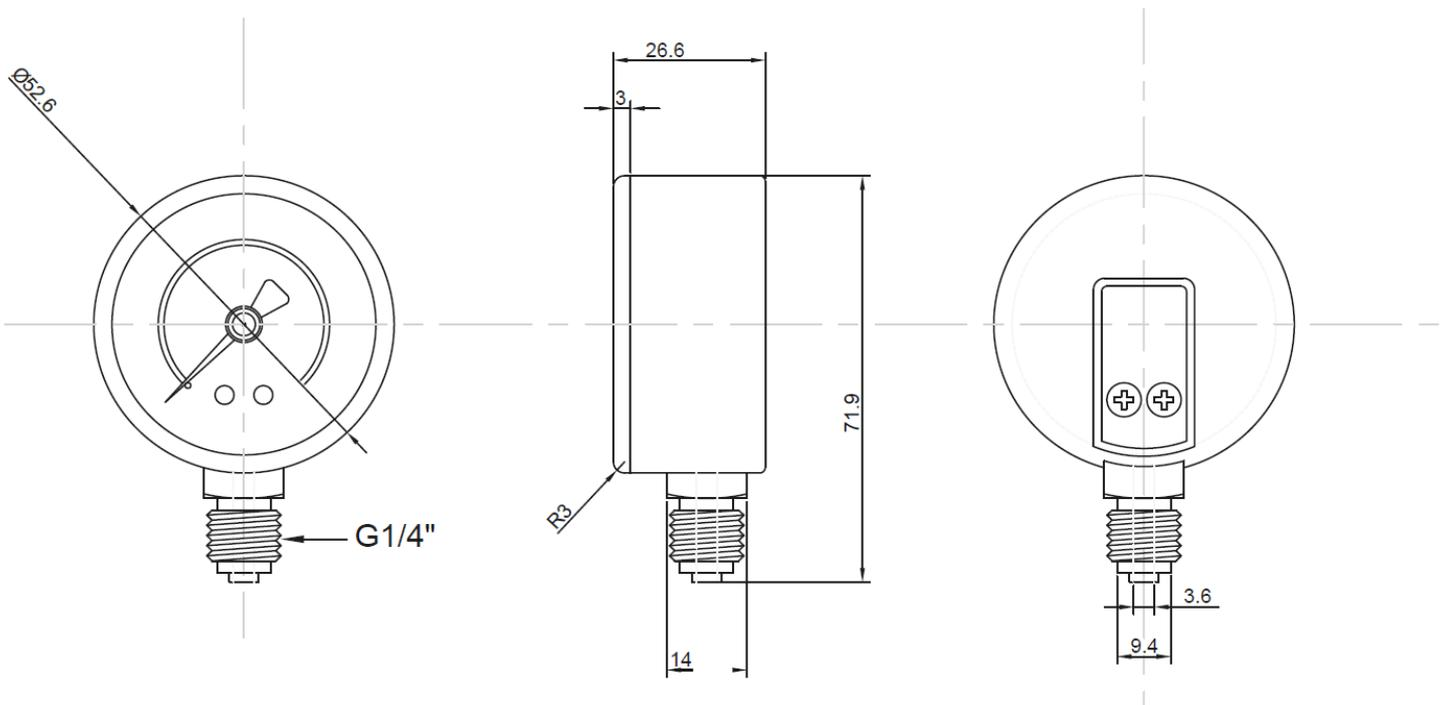
**Standardmanometer, Anschluss radial unten**
