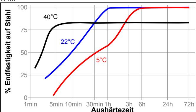
**Aushärtegeschwindigkeit in Abhängigkeit vom Aktivator**
